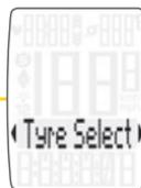
Ввод окружности колеса путем выбора размера шин из списка.
